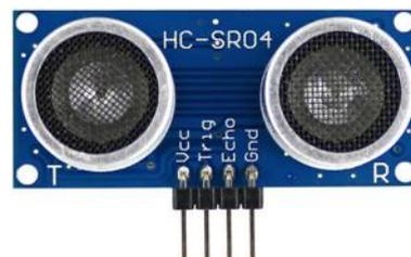
Gambar 2.4 Sensor *ultrasonik*
