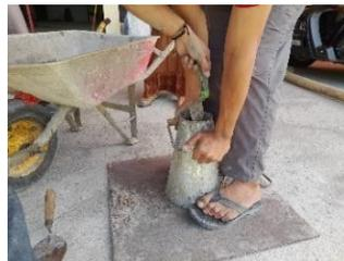
Gambar 3.13 Proses memasukkan campuran kedalam slump test
