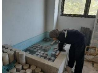
Gambar 3.21 Proses Perawatan Benda Uji
