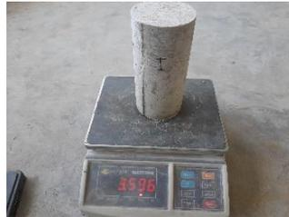
Gambar 3.25 Proses Menimbang Benda Uji
