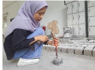
Gambar 3.44 Proses pembelahan spesimen
