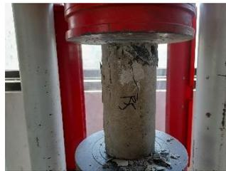
Gambar 3.28 Proses Pembebanan Benda Uji
