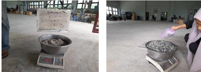
Gambar 3.11 Proses penimbangan bahan agregat
