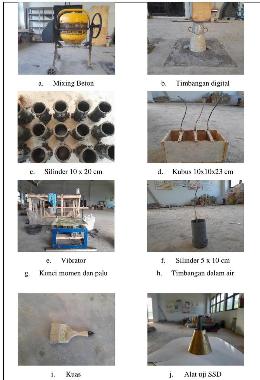
Gambar 3.10 Alat Pembuatan sampel benda uji
