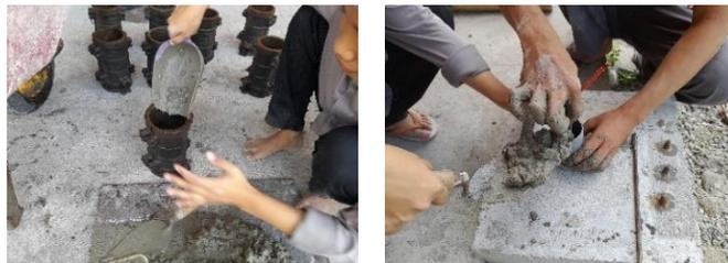
Gambar 3.17 Proses Pengisian Adukan Beton Kedalam Cetakan
