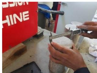
Gambar 3.26 Proses Pengukuran Diameter Benda Uji
