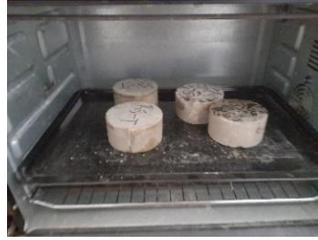
Gambar 3.32 Proses Mengoven Benda Uji
