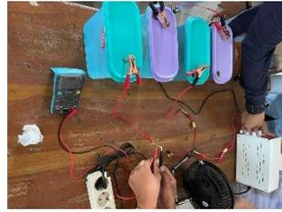
Gambar 3.41 Proses pembacaan arus pada multimeter
