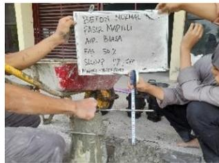
Gambar 3.16 Proses Pengukuran Hasil Uji Slump Test
