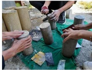
Gambar 3.24 Proses Pengamplasan Permukaan Beton
