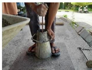
Gambar 3.14 Proses Penumbukan Slump Test
