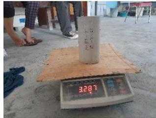
Gambar 3.33 Proses menimbang Benda Uji Setelah di oven 24 jam
