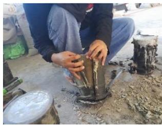
Gambar 3.19 Proses pelepasan benda uji dari cetakan
