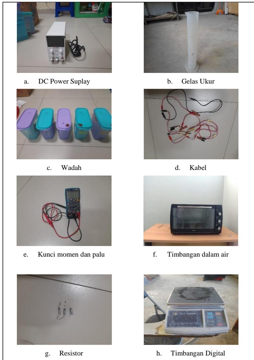
Gambar 3.36 Alat Pengujian Migration Test
