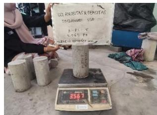
Gambar 3.31 Proses Menimbang Berat Benda Uji Kondisi SSD
