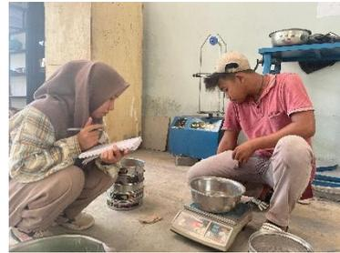
**Gambar 4 Pengujian analisa saringan agregat kasar**
