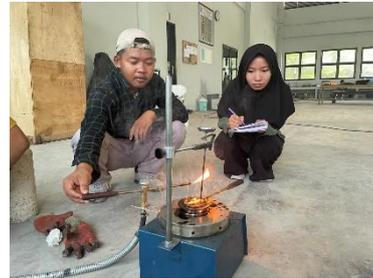
Gambar 2 Pengujian Titik Nyala dan Titik Bakar Aspal Pen 60/70
