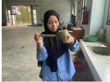
**Gambar 1 Pengujian berat jenis agregat halus**
