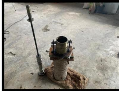
**Gambar 3.8** Cetakan silinder
