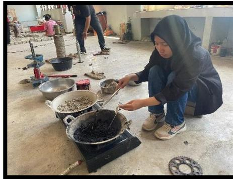
**Gambar 3.22** Pemanasan campuran dengan suhu  $140\text{-}160^{\circ}\text{C}$
