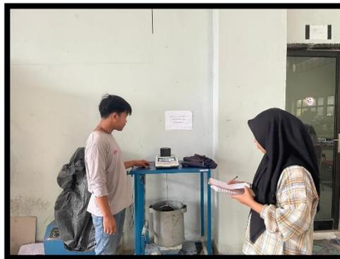
**Gambar 3.29** Timbang benda uji dalam keadaan SSD
