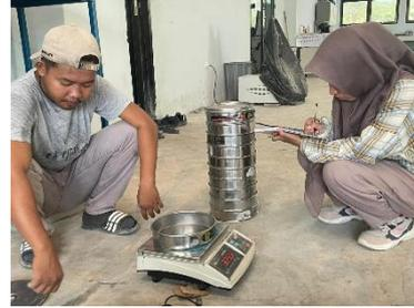
**Gambar 3 Pengujian analisa saringan agregat halus**
