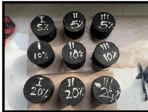
**Gambar 3.25** Diamkan benda uji dalam suhu ruang
