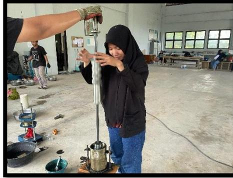
**Gambar 3.24** Pemadatan campuran dengan alat penumbuk
