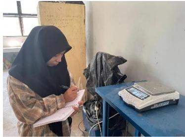
**Gambar 2 Pengujian berat jenis agregat kasar**
