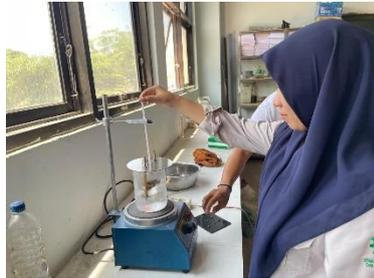
Gambar 1 Pengujian Titik Lembek Aspal Pen 60/70
