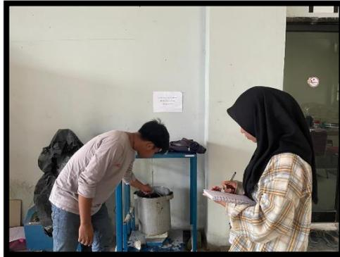
**Gambar 3.28** Timbang benda uji dalam air
