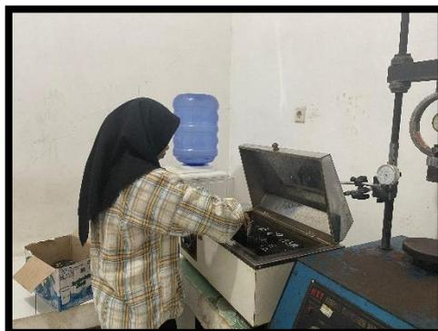
**Gambar 3.30** Rendam benda uji pada suhu  $60^{\circ}\text{C}$  selama 30 menit
