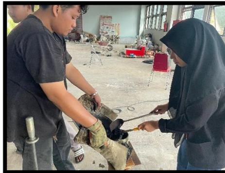
**Gambar 3.23** Memasukkan campuran kedalam cetakan benda uji
