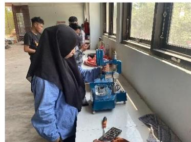
Gambar 4 Pengujian Pentrasi Aspal Pen 60/70
