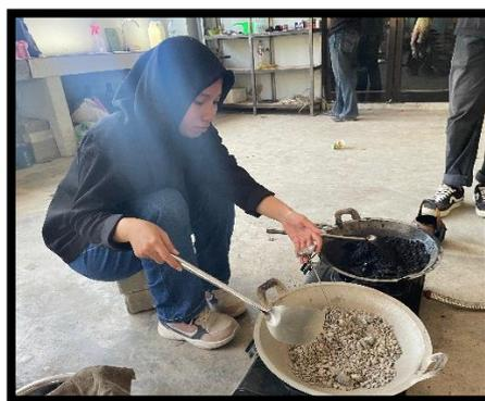
**Gambar 3.21** Memanaskan aspal dan agregat
