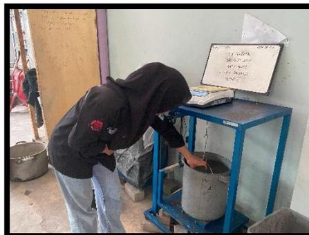
**Gambar 3.28** Proses penimbangan dalam air (D)
