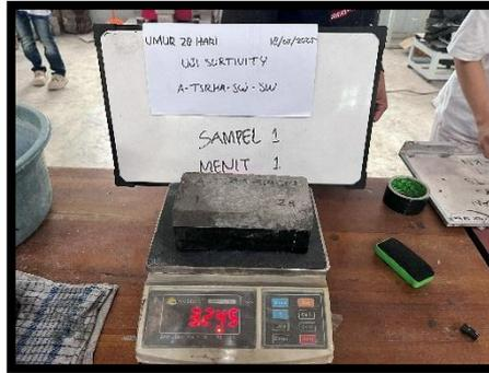
**Gambar 3.34** Timbang benda uji pada interval waktu 1 menit
