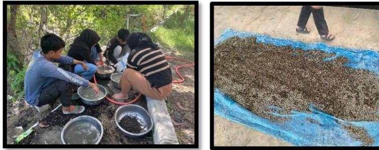
**Gambar 3.7** Proses pencucian dan penjemuran agregat kasar
