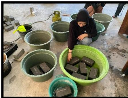
**Gambar 3.33** Proses memasukkan benda uji kedalam wadah
