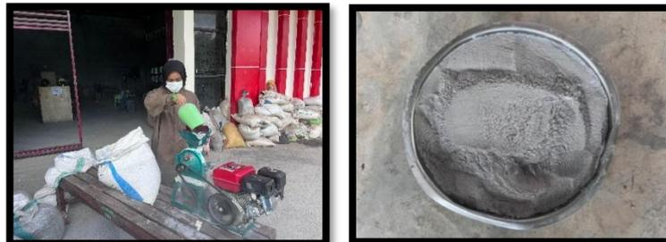
**Gambar 3.8** Proses grinding abu sekam padi sebanyak dua kali
