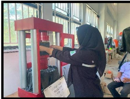
**Gambar 3.23** Letakkan benda uji
