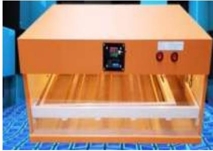
Gambar 4. Mesin Tetas Otomatis
