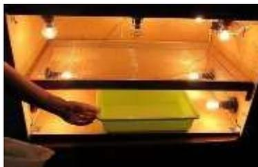
Gambar 2. Mesin Tetas Manual
