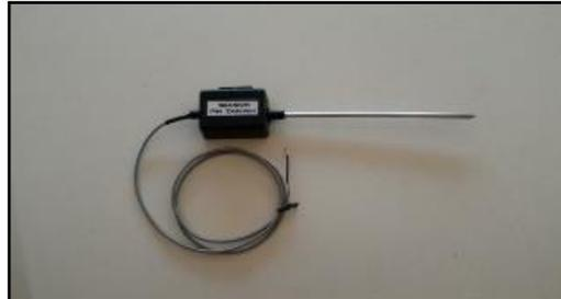
**Gambar 2.6** Sensor pH tanah
