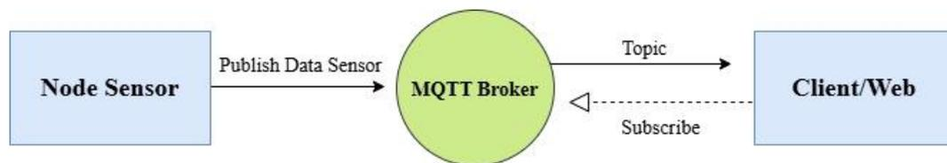
**Gambar 2.2** Alur Komunikasi data MQTT
