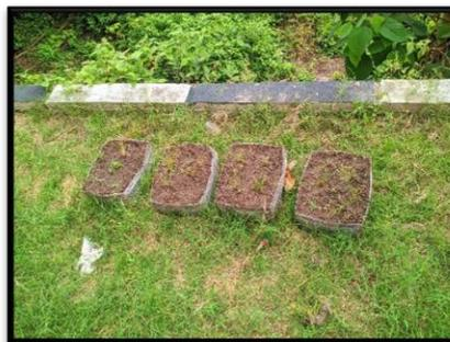
**Gambar 2.6** Pengujian Pertumbuhan Rumput pada Plat Beton Berpori
