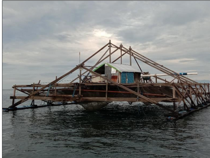
Gambar 1. Alat tangkap bagan apung Sumber: Dokumen Pribadi (2023)
