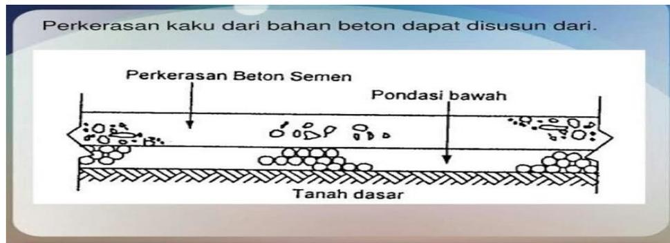
Gambar 2.2 struktur perkerasan jalan kaku
