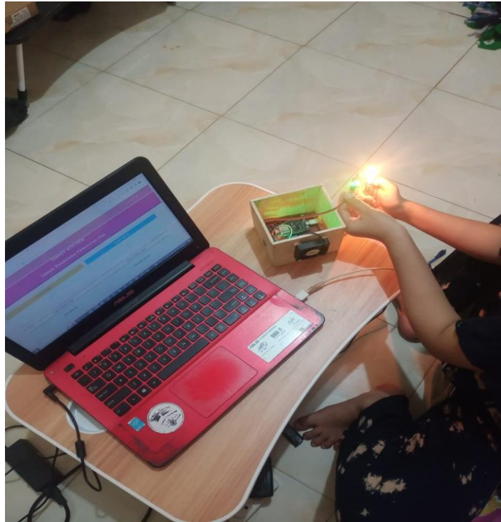
Gambar 4.7 pengujian sensor api
