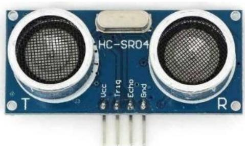
**Gambar 2.8. Sensor Ultrasonik**
