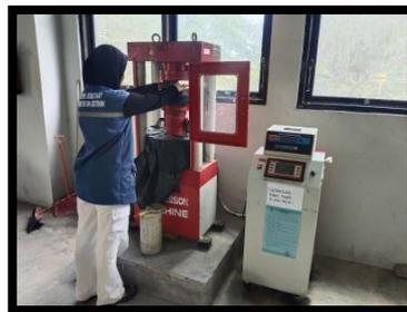
**Gambar 2.1** Uji Kuat Tekan Kubus (*Sumber : Dokumentasi Pengujian di Laboratorium*)
