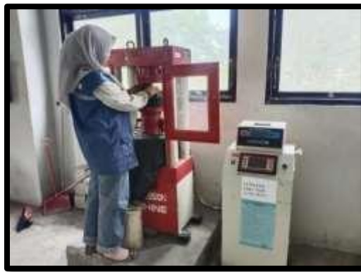
Gambar 2.1 Uji Kuat Tekan Beton Kubus 5 cm x 5 cm x 5 cm
